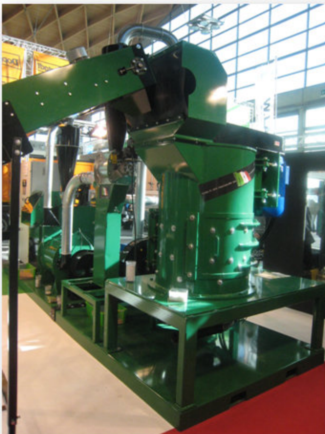
Oberes Bild: Die Vertikal- Prallmühle als Granulator Rechtes Bild: Der ZigZag Abscheider
