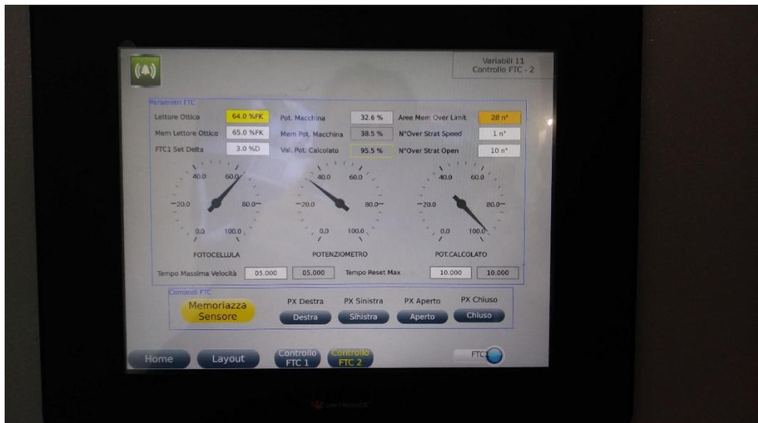
Bei Überschreiten des maximalen Fehlers erhöht die SPS selbstständig die Drehzahl des Lüfters für die Separation, so dass sich die fehlgeleiteten Partikel wieder nach hinten vom Abwurf wegbewegen. Bei Übersteuerung regelt die SPS ebenfalls und der Trennschritt gelangt wieder weiter nach vorne. Somit wird auch der Verlust von Kupfer in der Kunststoff-Restfraktion minimiert.
