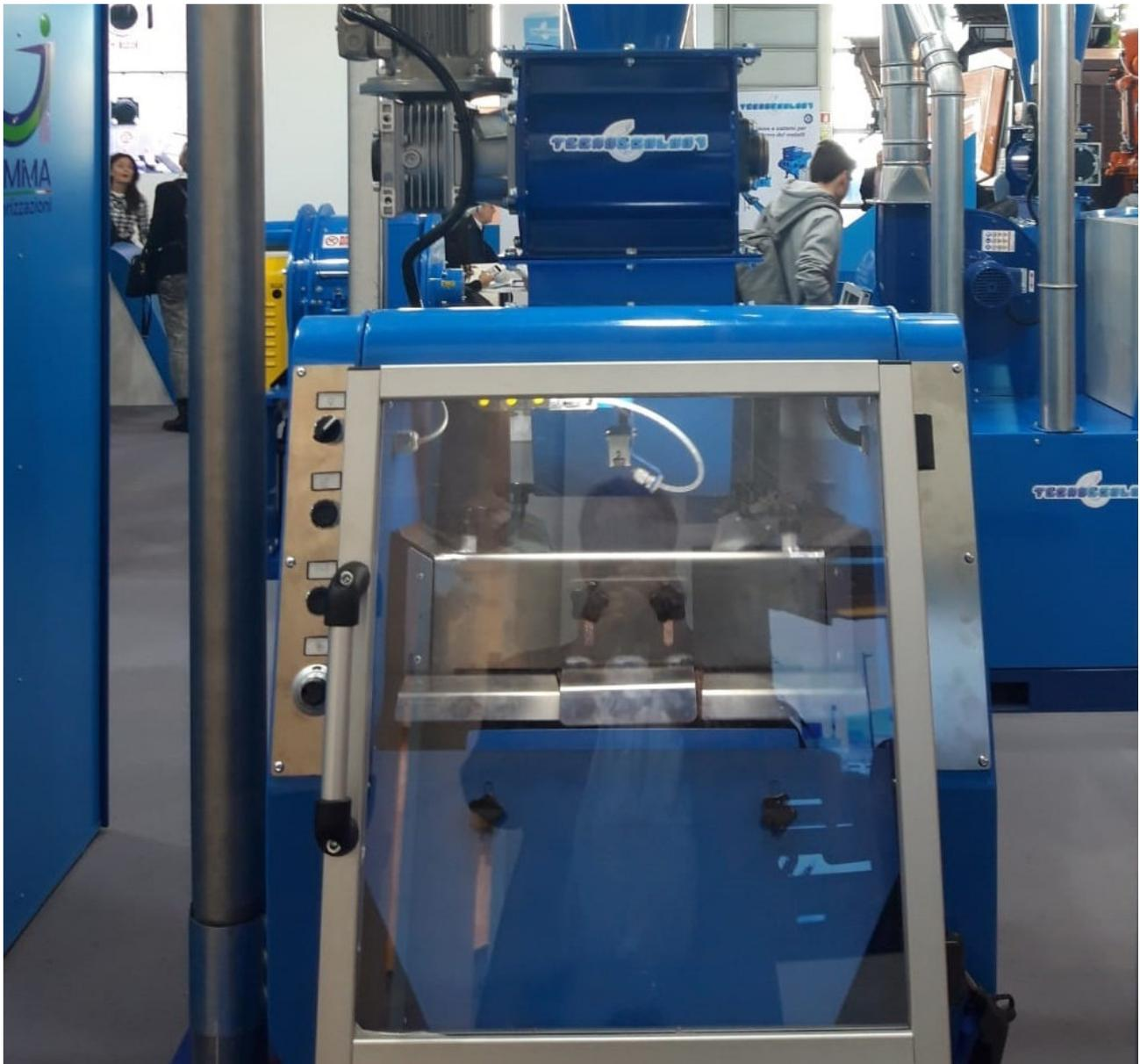
Um dieses zu verhindern, bietet Tecnoecology ab sofort für seine Separatoren eine Kontroll- und Steuereinheit an. Über dem Trenntisch ist an der Kupferseite ein Sensor angebracht, der periodisch von Seite zu Seite über das fertige Kupfer fährt. Dabei zählt die Elektronik die Anzahl von farbigen Partikeln und prüft, ob diese unter dem vorgegebenen Maximalwert liegt. Die Werte werden zudem auch auf dem Display visualisiert.
