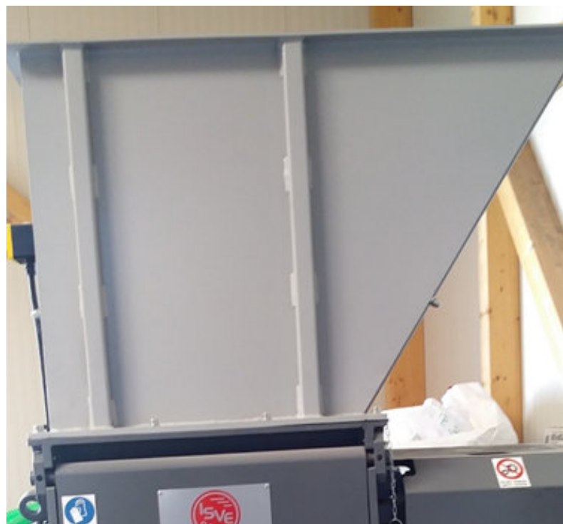
Bild 6: Senkrechte linke und vordere Trichterwand
